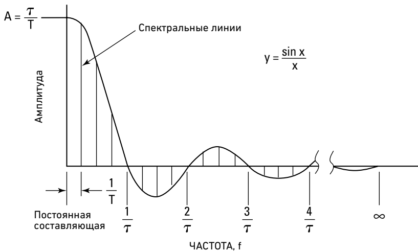
Рисунок 2 – Спектр идеального прямоугольного импульса. Амплитуды и фазы бесконечного числа гармоник изображены в результате сглаживания огибающей.
