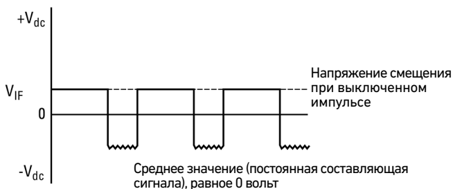
Рисунок 16. Компенсация напряжения смещения путём настройки разности фаз \Delta\theta_{LO-RF} , при которой обеспечивается среднее значение напряжения постоянной составляющей 0 вольт.
