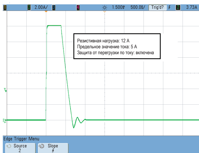
Рис. 2. Защита от перегрузки по току источника питания APS отключает выход
