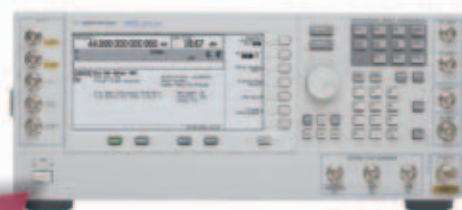
Векторный генератор сигналов E8267D PSG
