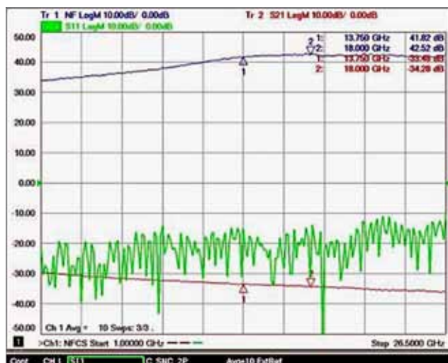
Рис. 5. Характеристики оптического канала длиной 1,5 км без предусилителя.
