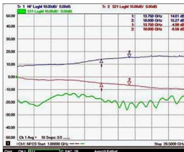
Рис. 6. Характеристики того же оптического канала с предусилителем M9405A.
