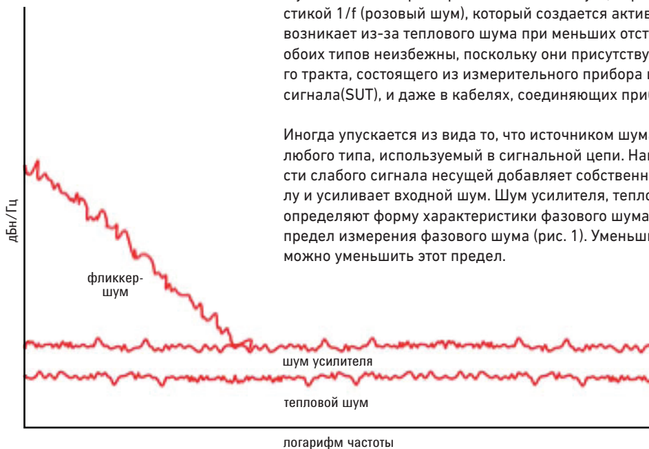
Рис. 1. Три основных составляющих шума определяют теоретический нижний предел измерения фазового шума.
