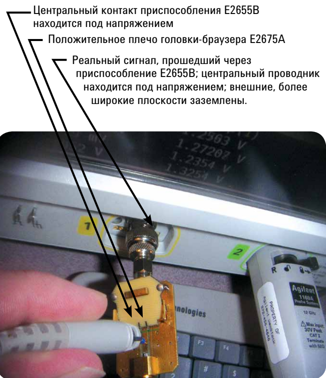
Рис. 4. Установка для выполнения измерений с помощью дифференциальной головки-браузера E2675A и усилителей пробников InfiniiMax I или InfiniiMax II. Эта головка пробника может также использоваться для измерений несимметричных сигналов путем заземления отрицательного плеча.
