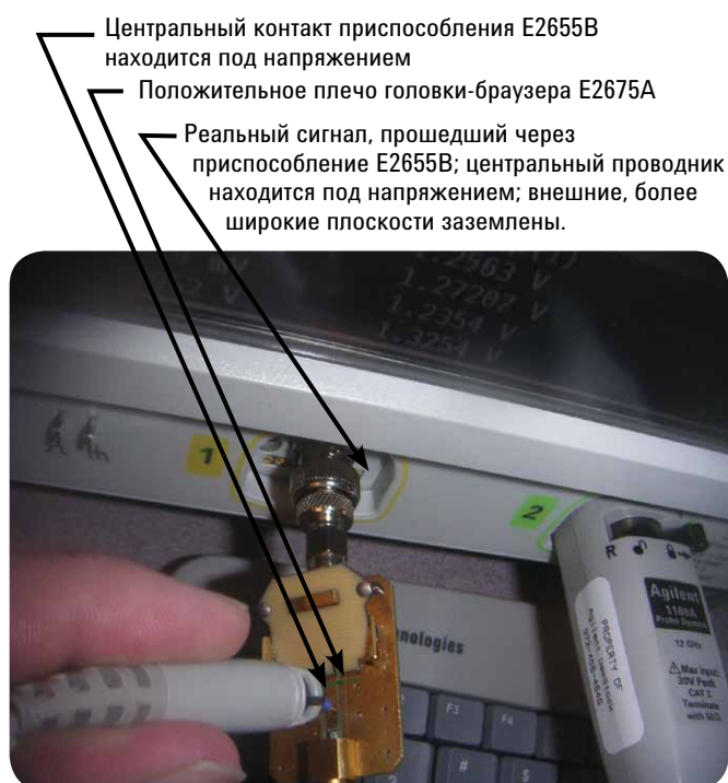
Рис. 19. Установка для проверки компрессии усилителя пробника.
