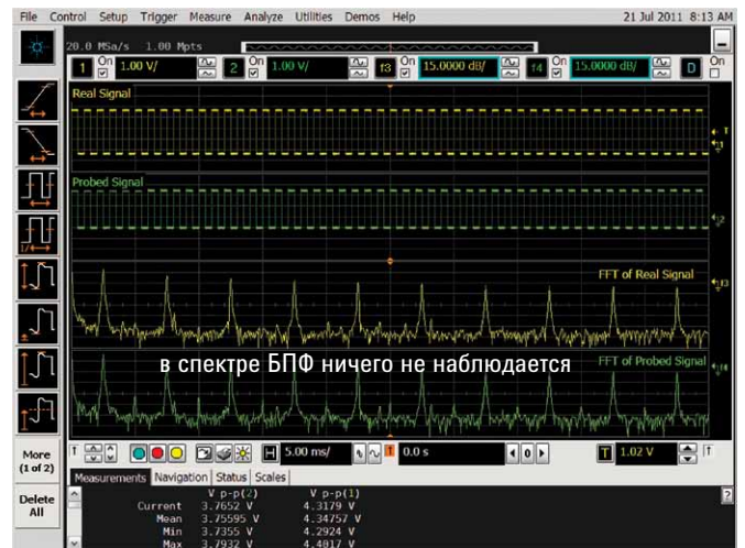
Рис. 21. Анализ спектра прямоугольного сигнала с целью выявления компрессии усилителя пробника.
