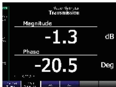
Использование векторного вольтметра для балансировки кабелей
