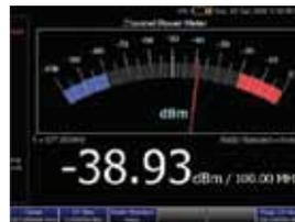
Встроенный измеритель мощности
