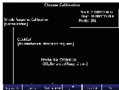
ЭТАП 1 Функция QuickCal анализатора FieldFox позволяет выполнять калибровку без использования калибровочного комплекта
