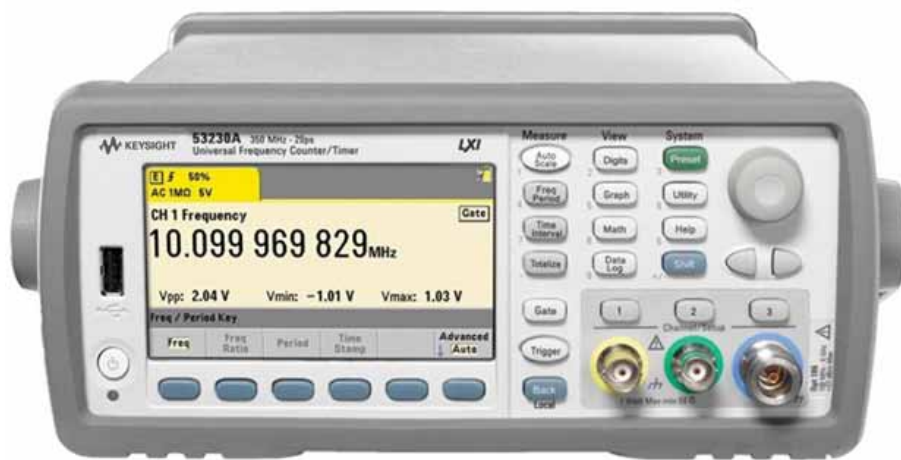
Рис. 5. Частотомер 53230A имеет два входных канала с полосой пропускания до 350 МГц и может быть оснащен третьим каналом с полосой пропускания до 6 ГГц (опция 106) или до 15 ГГц (опция 115).
