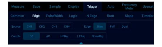
Figure 6-11 Edge Trigger Setting Menu
