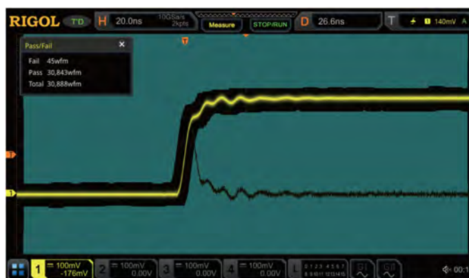
Функция допускового контроля позволит быстро получить для сигнала статистику о вероятности отклонений от нормы.
