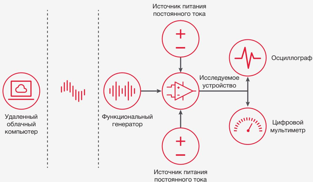
Рис. 1. Совместное использование приборов серии Smart Bench Essential для тестирования
