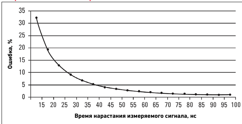
Рисунок 1. Ошибка измеренного времени нарастания в зависимости от времени нарастания измеряемого сигнала
