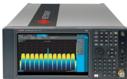
Рисунок 39. Анализатор сигналов PXA N9030B с функцией анализа 12 каналов спутниковой связи с помехами в режиме реального времени
