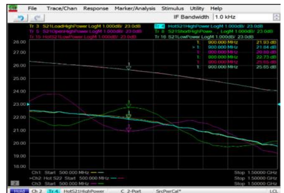
Измерение активного «горячего» параметра S22
