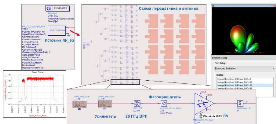
Совместное электромагнитное и схмотехническое моделирование с использованием САПР ADS
