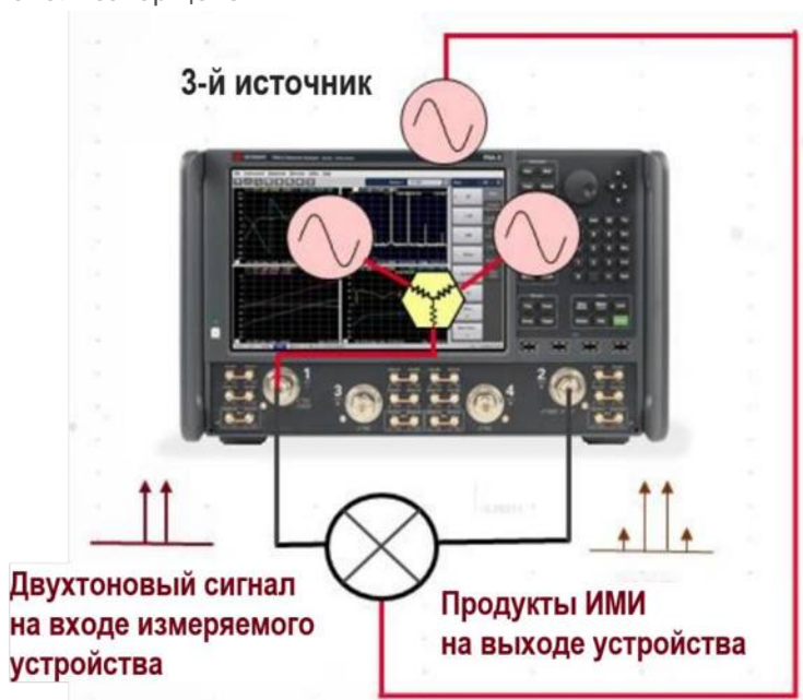
Рис. 4. Двухтоновые измерения ИМИ смесителя
