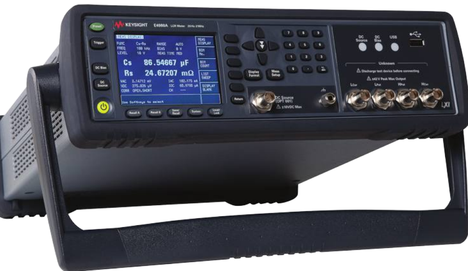
Рис. 8. Измеритель иммитанса Keysight E4980A измеряет ёмкость с субфемтофардным разрешением
