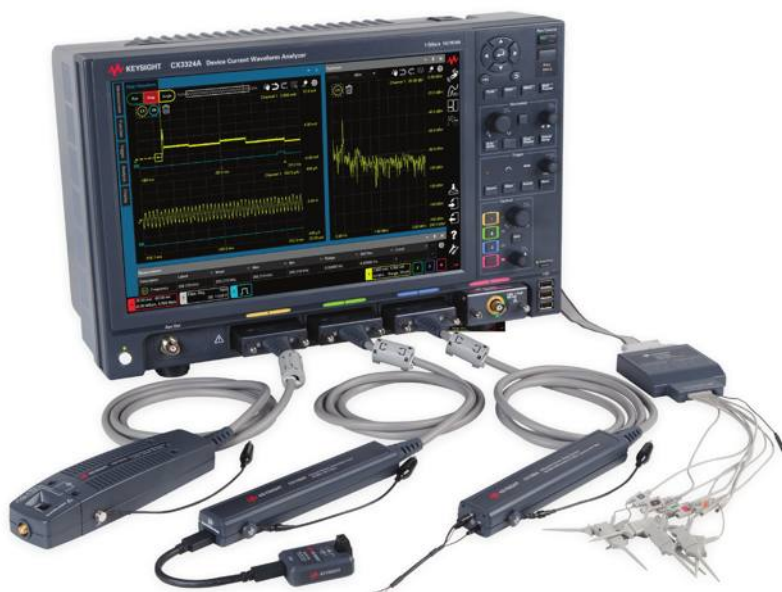
Анализатор формы потребляемого тока CX3300A
