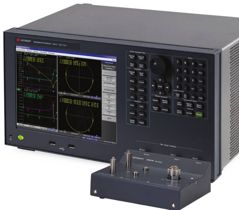
Рисунок 5. Анализатор импеданса Keysight E4991B
