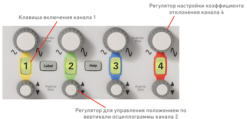
Рис. 16. Блок органов управления системой вертикального отклонения осциллографа Keysight серии InfiniiVision 2000 X.
