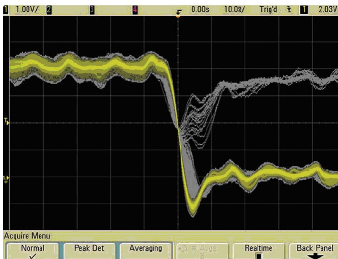
Рис. 19. Редкая случайная импульсная помеха, захваченная с помощью осциллографа Keysight серии InfiniiVision 6000.
