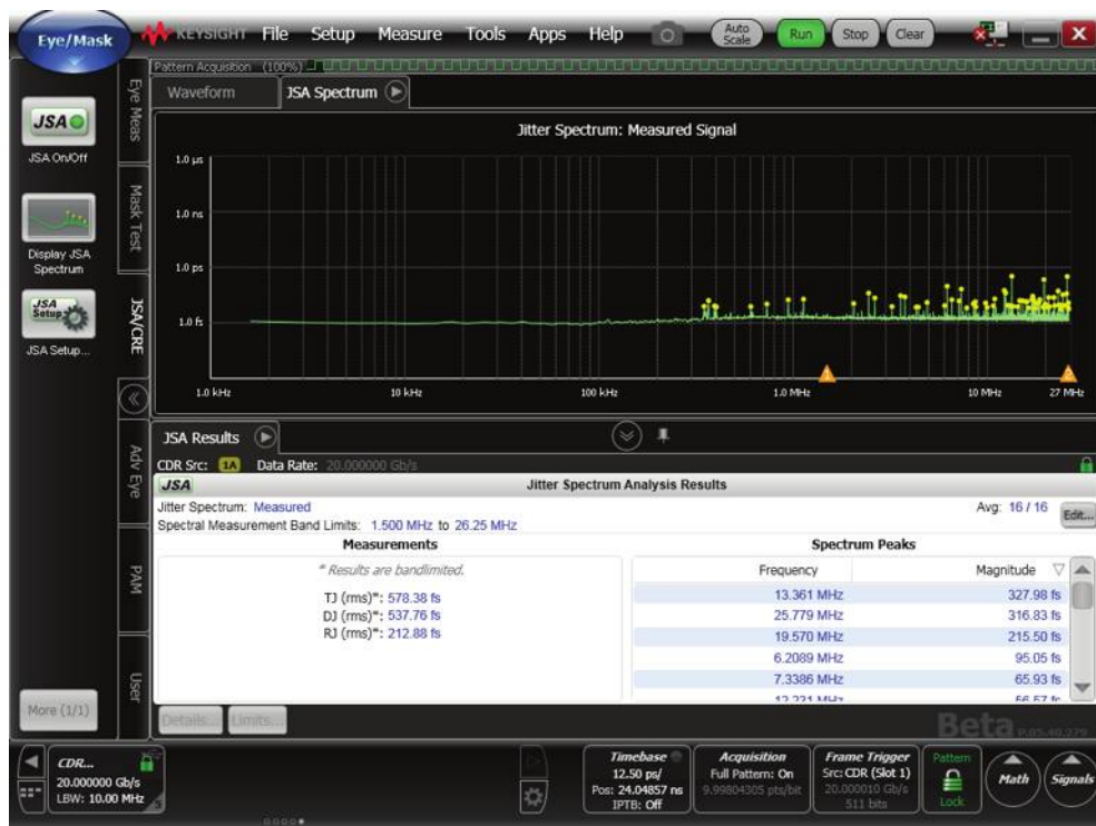
Рисунок 11. Функция анализа спектра джиттера (модели N107xA с опцией JSA) повышает точность в режиме измерений параметров джиттера (с использованием базового блока осциллографа 86100D с опцией 200/N1000A), измеряет низкочастотный джиттер (фазовый шум), а также дает понимание истинных причин появления джиттера.
