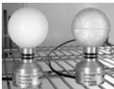
Рисунок 31: Сферические датчики BINDER для VIS и УФ-А измерения
