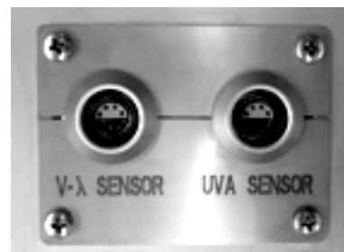
Рисунок 13: LEMO разъемы для подсоединения световых датчиков
