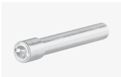
Контрольная течь с резьбовым штуцером
