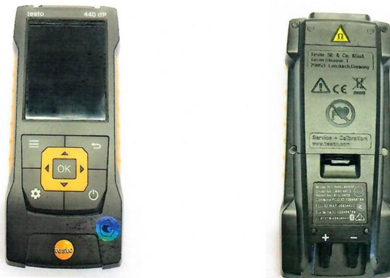
а) в качестве отдельной наклейки или б) на информационной этикетке Рисунок 2 – Место нанесения знака утверждения типа
