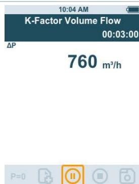
Этот метод определения объемного расхода можно использовать в том случае, если производитель трубопровода или элементов системы вентиляции предоставил соответствующие спецификации. Согласно этим спецификациям выполняется измерение разности давлений в указанном производителем или поставщиком месте. Объемный расход вычисляется на основании измерения разности давлений с учётом значения k-фактора по следующей формуле:
