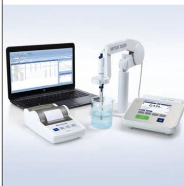
Подключайте сканер штрих-кодов, клавиатуру, USB-накопитель, USB-принтер или ПК с ПО EasyDirect™ pH, чтобы повысить эффективность и расширить возможности прибора SevenCompac1™. В этом вам также помогут держатель датчика uPlace и мешалка uMix.
