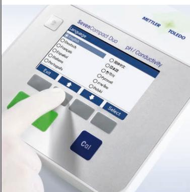
Для измерения, запуска калибровки или переключения между режимами требуется лишь одно нажатие клавиши. Для настройки параметров прибор SevenCompac1™ предлагает развернутое меню на 13 языках. Больше никаких непонятных сокращений!
