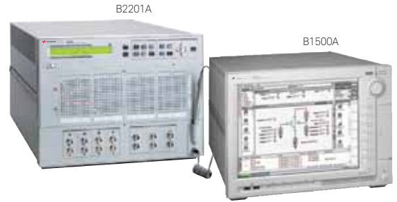
Решение для измерения ВФХ-ВАХ по 4-проводной схеме Кельвина при токе 10 фА
