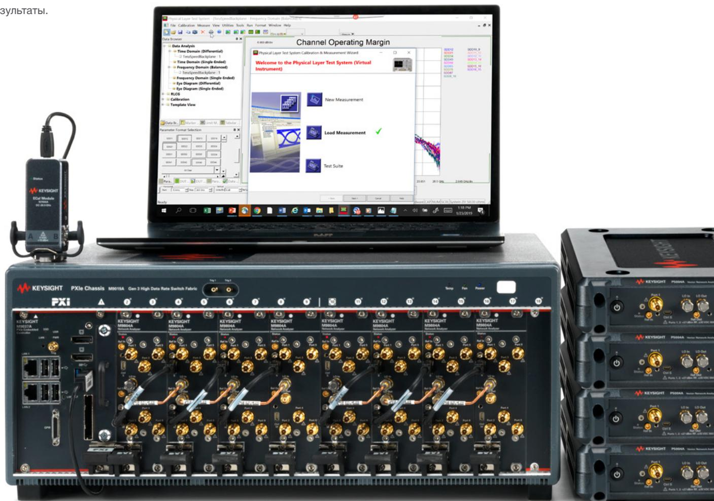
Шасси M9019A формата PXI с векторными анализаторами цепей M9804A PXI
