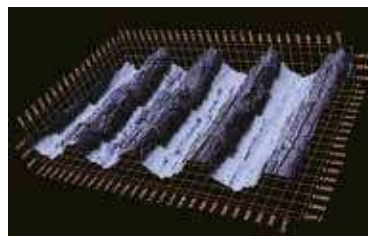
Трехмерный вид поверхности (образец, взятый из теста на определение шероховатости поверхности)
