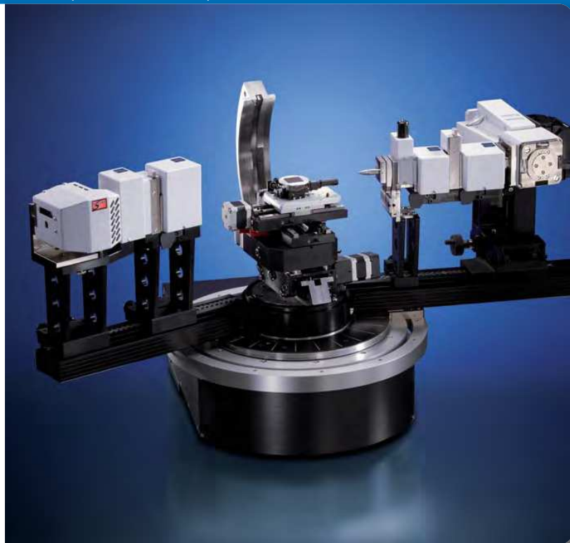
Конфигурация с горизонтальным гониометром и подвеской Эйлера для измерения в геометрии скользящего пучка
