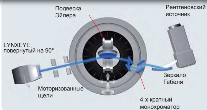
HRXRD конфигурация с 4-х кратным монохроматором
