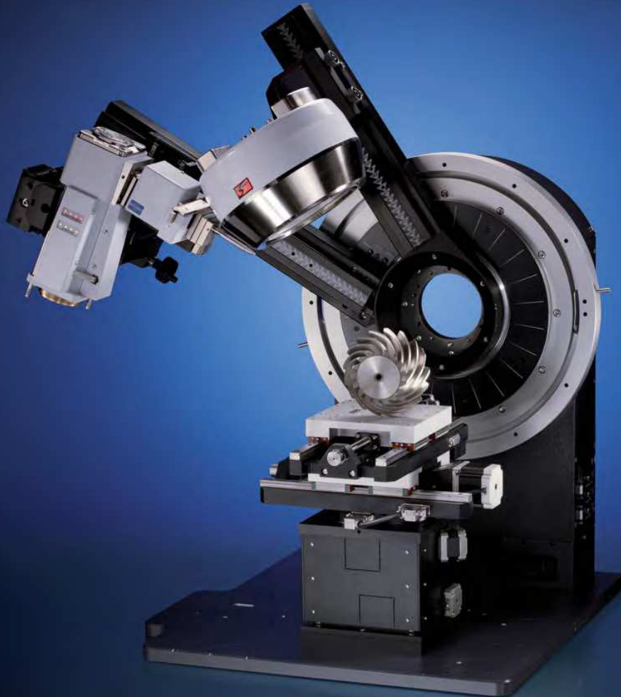
Конфигурация для анализа остаточных напряжений, включающая детектор VECF500 и держатель образцов с весом до 50 кг
