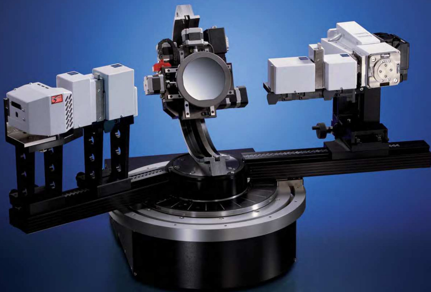
HRXRD конфигурация с 4-х кратным монохроматором
