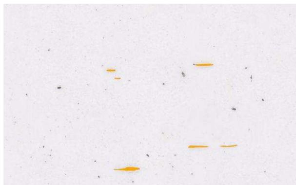
Фрагмент панорамного изображения (слева - изображение микроструктуры, справа - наложение автоматически выделенной маски неметаллических включений)
