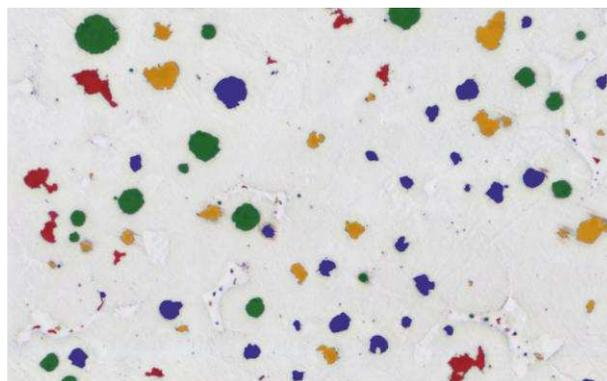
Фрагмент панорамного изображения (слева - изображение микроструктуры, справа - наложение автоматически выделенной маски графита)
