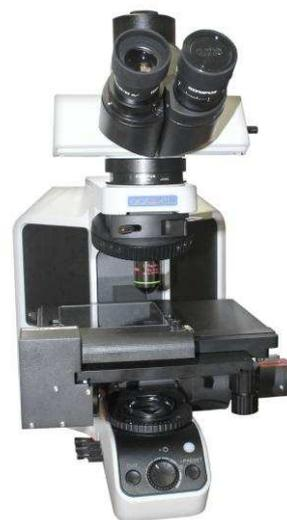
Системы панорамной микроскопии SIAMS работают на базе оптических микроскопов. Для работы микроскопа не требуется оснащение моторизованным столиком. Все микроскопы комплектуются штатными механическими предметными столиками и видеокамерами высокого разрешения.
