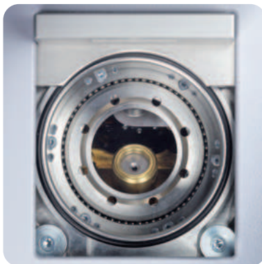
Вращение образцов для точности и воспроизводимости результатов
