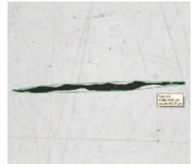
Определение включений по наилучшему полю (сталь с неметаллическими включениями)
