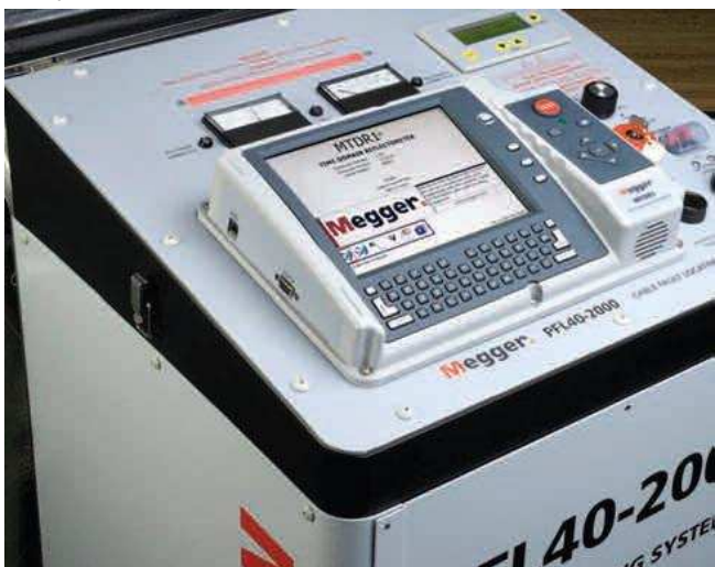
MTDR1 , смонтированный на установке для поиска повреждений кабеля Megger PFL40A
