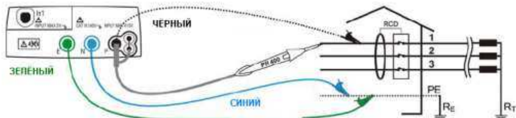
Рис.14: Подключение прибора для проверки УЗО в 3 пр трехфазной сети 400В + PE (нет N) при помощи отдельных измерительных проводов или опционального щупа-пробника
