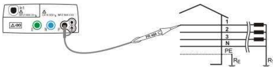
• Рис. 24: Подключение прибора для определения правильности чередования фаз при использовании 1-го измерительного щупа-пробника ( подключение к фазе 1 )
