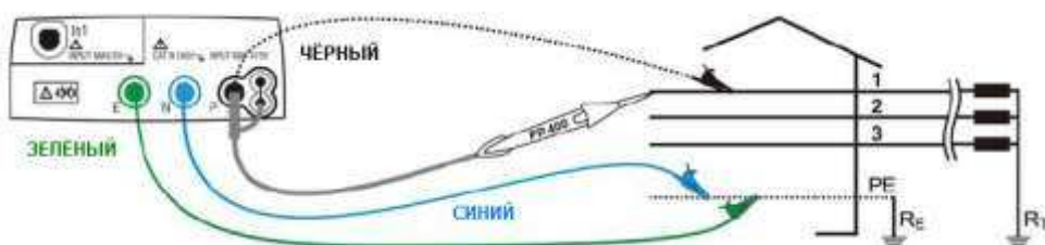
Рис.19: Подключение прибора для измерения полного сопротивления цепи P-PE в трехфазной сети 400В + PE (no N) при помощи измерительных проводов или опционального щупа-пробника
