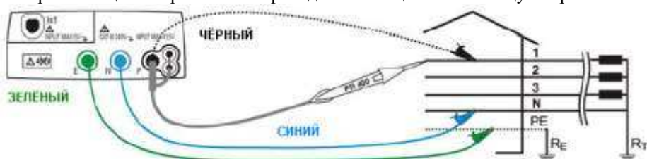
Рис.17: Подключение прибора для измерения полного сопротивления цепи P-N и петли P-PE в трехфазной сети 400В + N + PE при помощи измерительных проводов или опционального щупа-пробника
