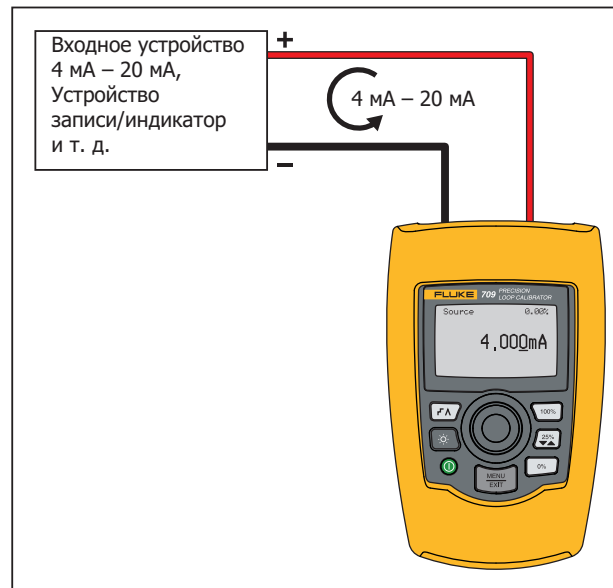
Рисунок 4. Соединения для подачи тока
