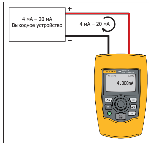
Рисунок 6. Соединения для измерения тока
