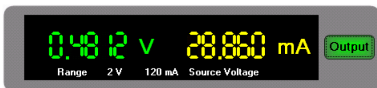
Рис. 2-3 Включение выхода блока U2722A/U2723A
