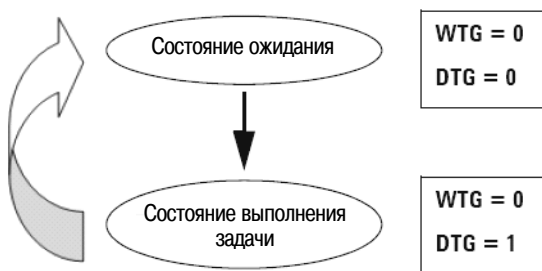
Рис. 2-16 Состояние канала и бит регистра статуса рабочего состояния при дистанционном запуске
