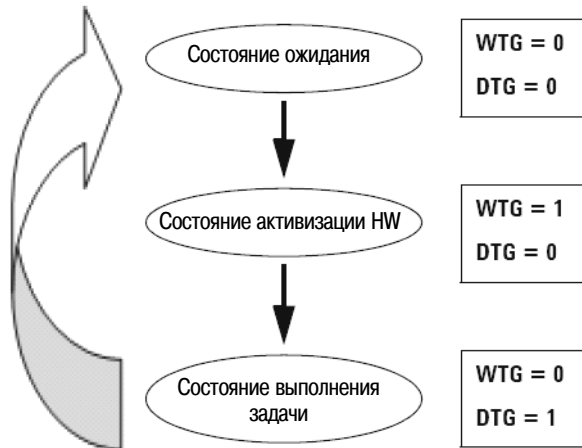
Рис. 2-15 Состояние канала и бит регистра статуса рабочего состояния при внешнем запуске
