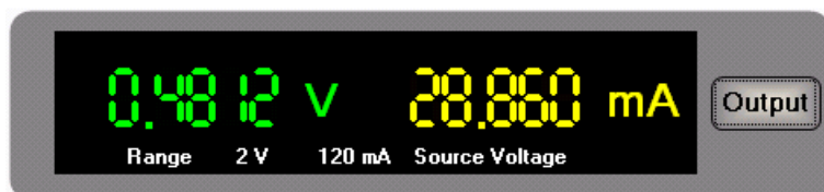
Рис. 2-4 Выключение выхода блока U2722A/U2723A
